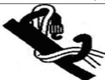
Репшнур вщелкивается в карабин, при открытом карабине делается 3—4 оборота, затем муфта карабина закручивается, узел распрямляется и затягивается.
