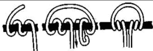
Узел завязывается репшнуром (6 мм) на основной веревке (диаметром 10—12 мм). Репшнур складывается пополам, им обносится веревка. Затем операция повторяется. После этого узел затягивается, распрямляется и завязывается контрольный узел. Контрольный узел не нужен, если репшнур предварительно завязан в петлю узлом «встречный» или «грейпвайн».
