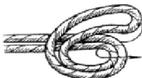
Отмеряем нужной длины конец веревки. Вяжем простой узел и расправляем его так, чтобы веревки не прилегали плотно друг у другу. Расправляем узел для равномерного нагружения веревки. Вяжем контрольный узел
