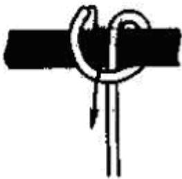
Узел вяжется одним концом веревки вокруг опоры. Ходовой конец веревки обносится вокруг опоры, затем вяжется так, как показано. После этого узел затягивается и закрепляется контрольным узлом. Если узел «стремя» используется при прикреплении к опоре, он затягивается как можно сильнее, а контрольный узел вяжется как можно ближе к опоре.
